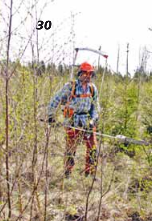
Södras tester visar att de som arbetar med kedjeröjsåg har 10-15 procents lägre puls än de som arbetar med traditionell utrustning på samma mark.
